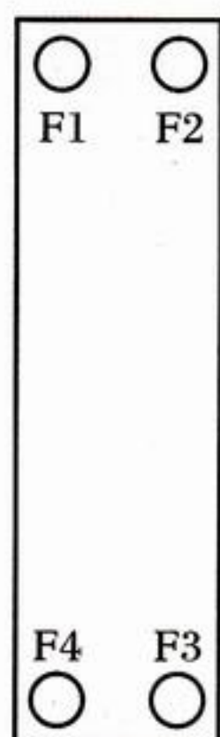
固定压紧板 从换热器固定端观察
